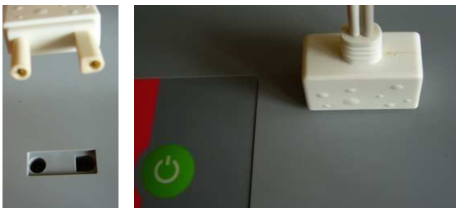
Fig. 9: Tilslutning af elektrodestikket
